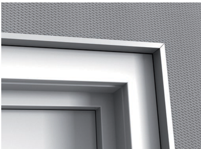
3.9 Wykończenie profilem obwiodowym J wokół drzwi lub okna powinno być zawsze wykonywane tak aby profil obwiodowy J był zamontowany ścianką o szerokości 25 mm do ściany, przykręcony wkrętami co 300 mm i 30 mm od końców do ściany. Aby zminimalizować straty paneli, należy ostrożnie mierzyć i przycinać, zapewniając jednocześnie odpowiednie nakładanie się profili obwiodowych J.
